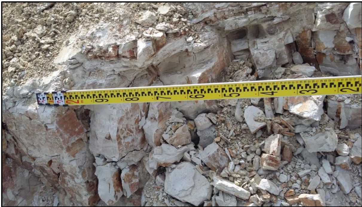
Figura 6 Particolare del livello vulcanoclastico affiorante durante gli scavi in area Belloni per la realizzazione delle SAE.
